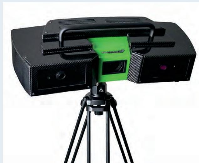
Skener je vybaven vyměnitelnými prachovými filtry pro práci v prašném prostředí. Konstrukce boxu skeneru z karbonu dává vyšší teplotní stabilitu. Součástí dodávky je profesionální přepravní kufr pro převoz a manipulaci a kvalitní stativ s nastavitelným natočením pro automatický sběr dat. Jako opce je dostupný rotační stůl, softwarové rozšíření a další. Skenery Smarttech 3D jsou certifikovány, dle normy VDI / VDE 2634.
