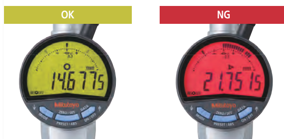
Kontrola tolerance zrakem
