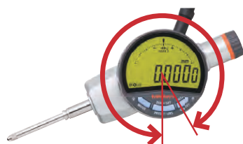
Mechanismus otočný o 330°
