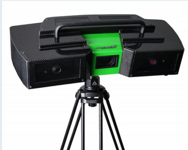
Skener je vybaven vyměnitelnými prachovými filtry pro práci v prašném prostředí. Konstrukce boxu skeneru z karbonu dává vyšší teplotní stabilitu. Součástí dodávky je profesionální přepravní kufr pro převoz a manipulaci a kvalitní stativ s nastavitelným natočením pro automatický sběr dat. Jako opce je dostupný rotační stůl, softwarové rozšíření a další. Skenery Smarttech 3D jsou certifikovány, dle normy VDI / VDE 2634.
